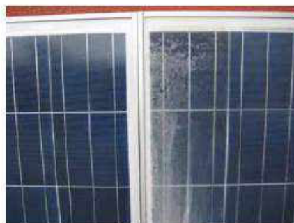
Bild 5: Schadenbild rechts nach dem DLG-Ammoniaktest (Quelle VDE / DLG)
