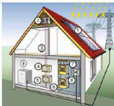
Bild 1: prinzipieller Aufbau einer PV-Anlage (Quelle: DGS)
