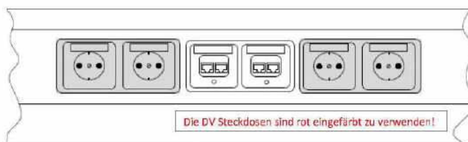
Abbildung 5: Ausstattung eines Standard-DV-Arbeitsplatzes im Tertiärnetz mit Kupferkabeln
