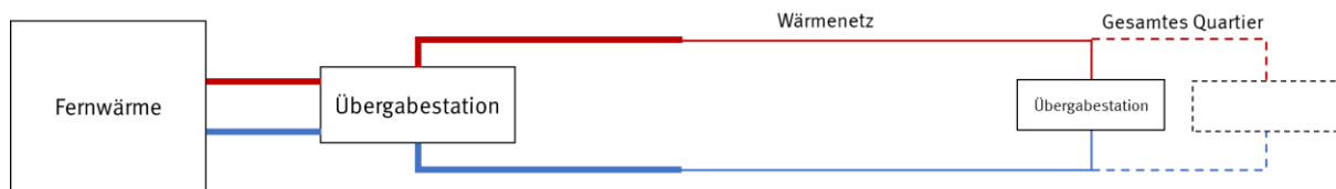
Abbildung 23: Schematisches Wärmeflussbild der netzgekoppelten Versorgung der Variante #0
