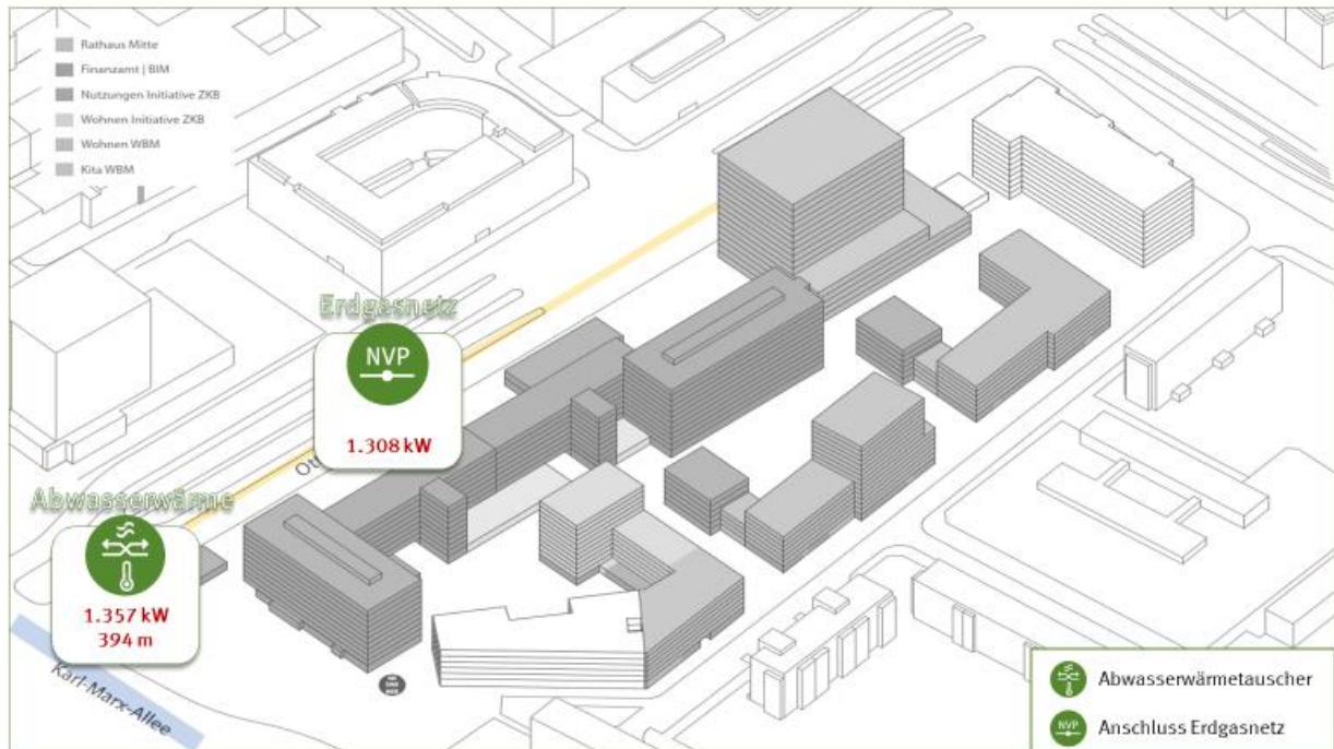
Abbildung 46: Schematische Darstellung des Abwasserwärmetauschers sowie des Gasanschlusses für Variante #4 inklusive Angaben zu Entzugs- und Anschlussleistung sowie der Wärmetauscherlänge
