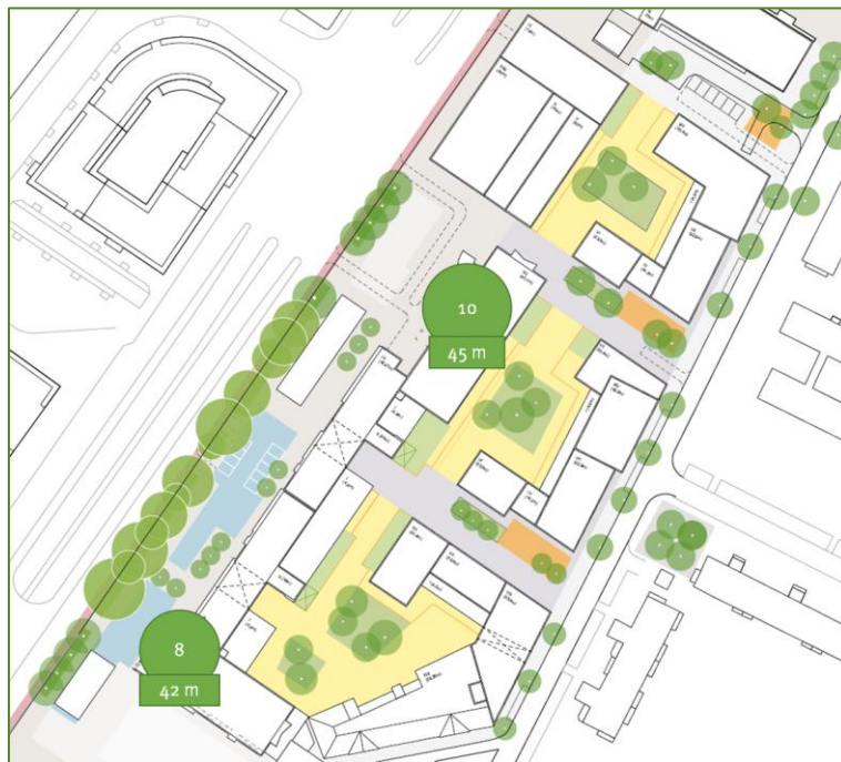
Abbildung 106: Gebäudespezifischen Potential der Kleinwindanlage Antarktis 3,5 kW.
