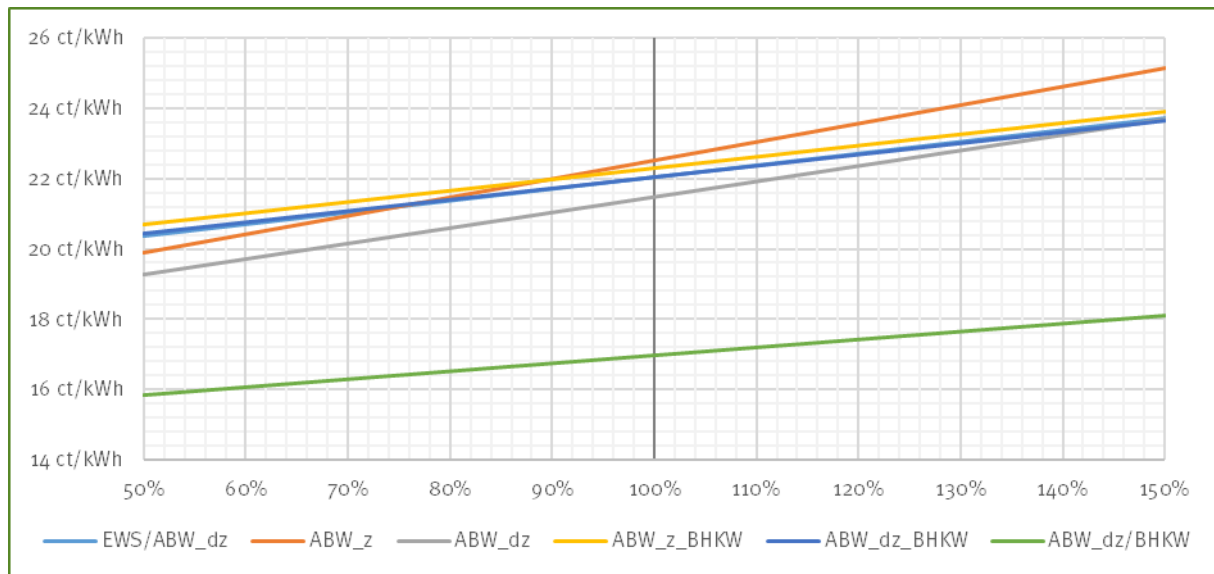
Abbildung 69: Änderungen der Brutto-Wärmepreise in Abhängigkeit prozentualer Änderungen des Arbeitspreises der Stromtarife für Wärmepumpen für alle untersuchten Varianten
